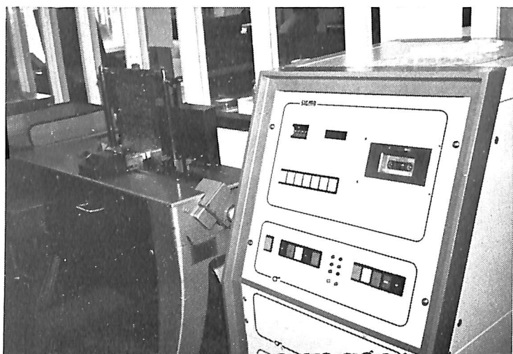
自動製版機（RINB） 現在、RNIB製4台とドイツ・マールブルグ製1台が稼動。亜鉛板1枚を、RINB製は10分、ドイツ製は5分で打つ。
