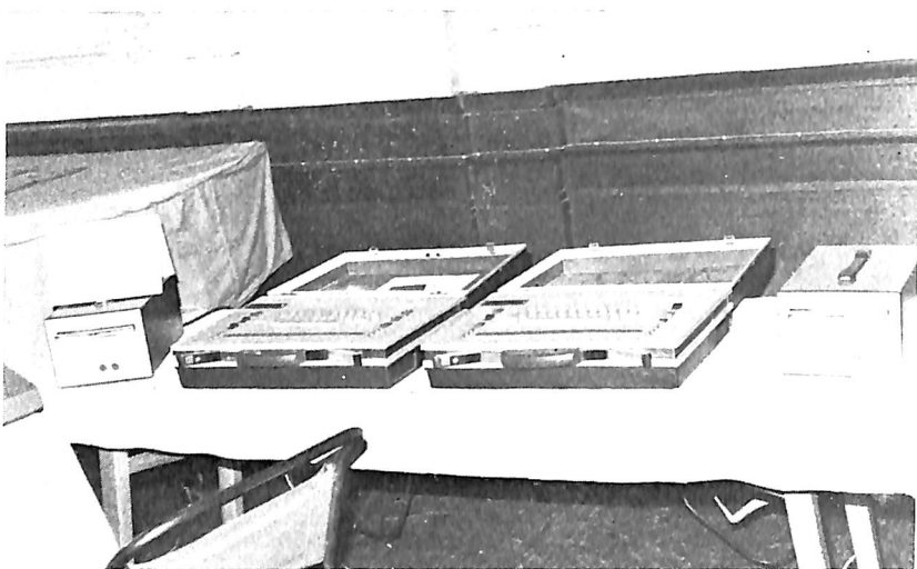
写真7 クラーク・アンド・スミス社の点字コンピューター端末装 置 ブレイリンク (イギリス)
