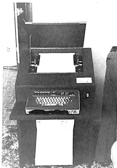
写真1 トリフォメーション社の点字 印刷機LED-120(アメリカ)
