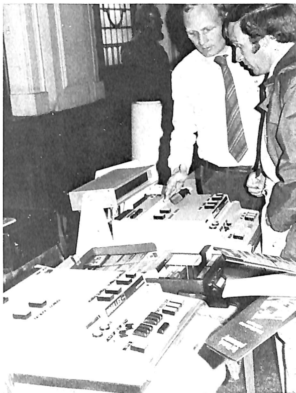
写真4 パーベンマ イヤー社のペーパー レス・ブレイル装置 ブレイレックス (西ドイツ)
