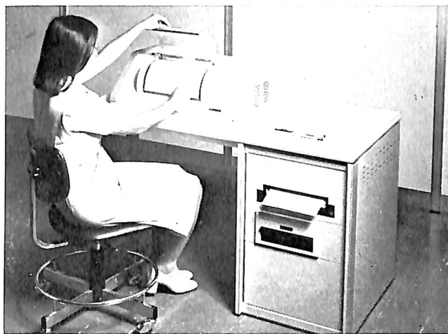
No. 8 点字紙を約30 秒で読み取り、カナ 文に翻訳する装置。 読み取った内容をフ ロッピーディスクに ファイルする機能も ある。工業技術院か らの委託による「点 字複製システムの研 究開発」における技 術を使用。
