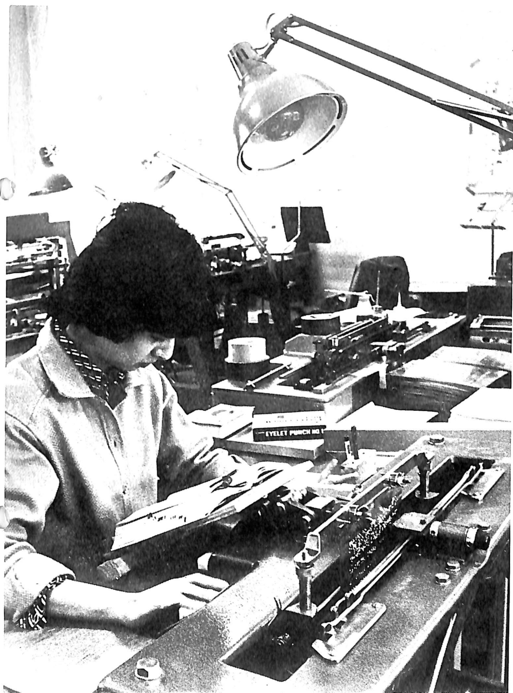
点字製版：製版機で亜鉛板に凹凸をつける。
