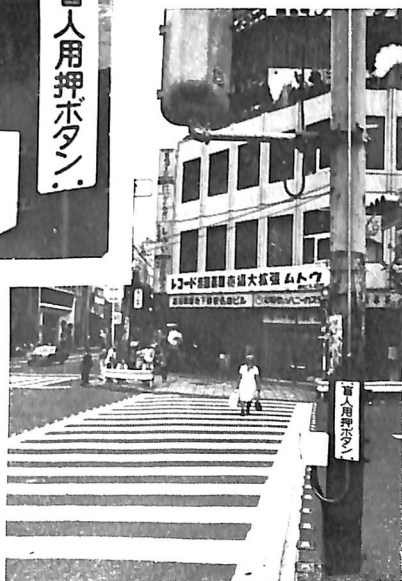
盲人用押ボタン。信号が青になる瞬 間にボーンという音を出します。
